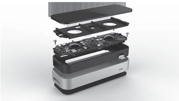
Fig. 1. Leap Motion Sensor Inside
