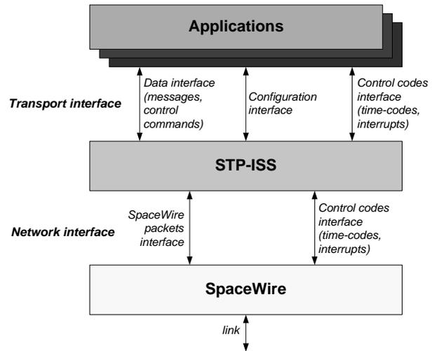
Fig. 4. STP-ISS interfaces
