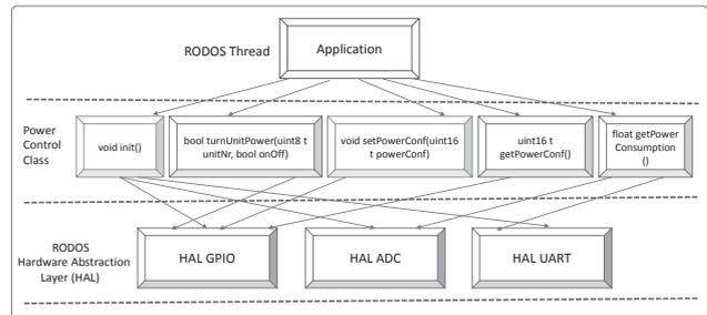
Fig. 13. PDU Software Abstraction Layer
