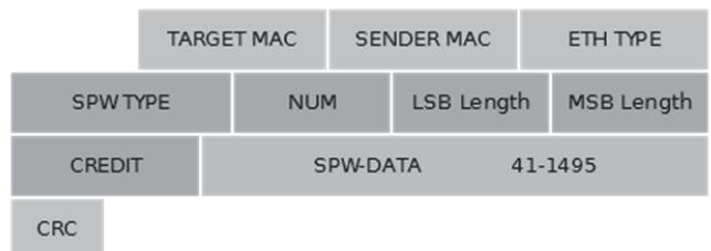
Fig. 1. Ethernet-SpaceWire frame
