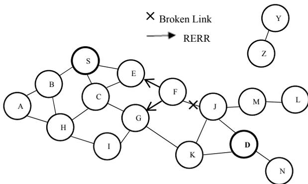
Fig. 1. Link breakage
