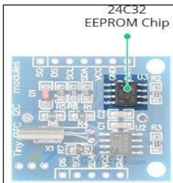
Fig. 6. Onboard 24C32 EEPROM
